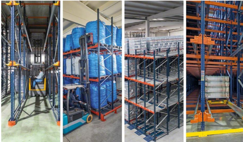
Cuatro sistemas de almacenaje por compactación: estanterías drive-in, push-back, dinámicas y Pallet Shuttle
