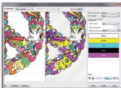
Figura 3.20. El proceso de vectorización automática en PowerTRACE, realizando la reducción de colores en el mismo proceso de vectorización. Los 13 colores de la imagen bitmap original se redujeron a 5 (incluyendo el blanco) dando como resultado un gráfico vectorial formado por 111 objetos.
