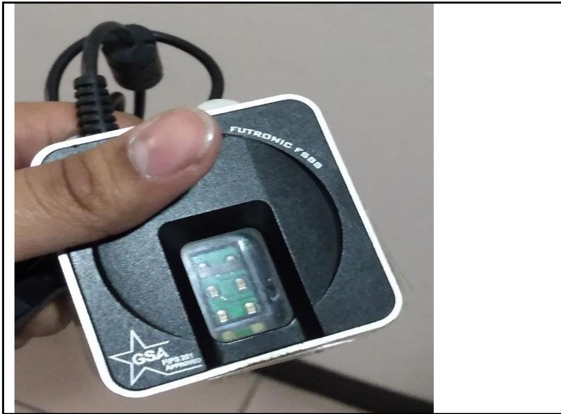
Figura 31: Capta huellas Futronic FS88. Fuente propia (2025)
