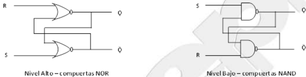
Figura 34.- Flip S-R, nivel bajo NOR, nivel alto NAND
