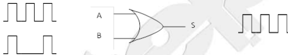
Figura 10.- Tren de Impulsos aplicado a Compuerta OR
